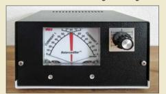
Dort, wo sich ein Messinstrument für den Antennenstrom elektrisch am günstigsten in die Zweidrahtleitung einfügen lässt, steht es mitunter an einem schlecht ablesbaren Platz. Den Ausweg bietet eine räumliche Trennung zwischen Stromwandler und Anzeige. Dieses Selbstbauprojekt zeigt, wie dies mit einer einfachen, drahtgebundenen Lösung möglich ist. Foto: DF2BC
