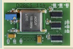
In der Elektronik und Funktechnik werden oft Referenzsignale mit sehr hoher Frequenzstabilität benötigt. Eine Möglichkeit, diese zu erzeugen, bieten Quarzoszillatoren mit geregelter Heizung. Solche OCXOs stehen heutzutage als kompakte Bauelemente zur Verfügung, die sich auch im Hobbybereich gut einsetzen lassen, wie das hier vorgestellte Selbstbauprojekt beweist.
