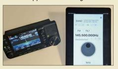
Der IC-705 besitzt eine Bluetooth-Schnittstelle, die sich zur Fernsteuerung des Geräts nutzen lässt. Auch eine passende App ist inzwischen verfügbar. Im Beitrag geht es um die erforderlichen Einstellungen an Transceiver und Software sowie die Möglichkeiten und Grenzen dieser Anwendung. Foto: DC4KU
