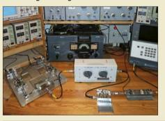
Um mit einem Messplatz den Intermodulationsabstand dritter Ordnung und somit den Interzeptpunkt eines Empfängers ermitteln zu können, muss die Messvorrichtung besser sein als das Messobjekt. Im Beitrag wird der Aufbau eines Zweikanalquarzfilters mit Hybridcombiner beschrieben, das sich für exakte Messungen eignet.
