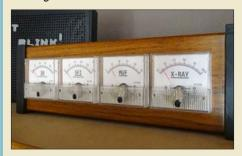
Aktuelle Solardaten zum Funkwetter findet man im Internet und lässt sie sich üblicherweise auf dem PC-Monitor anzeigen. Das hier beschriebene Selbstbauprojekt bietet eine originelle Alternative, indem es analoge Zeigerinstrumente zur Datenausgabe nutzt. In ein optisch ansprechendes Gehäuse eingebaut, ist das Gerät ein Blickfang fürs heimische Shack. Foto: DO1ATM
