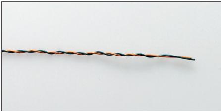
**Bild 3: Vorbereiteter bifilarer Wicklungsdraht für den Übertrager Ü1**
