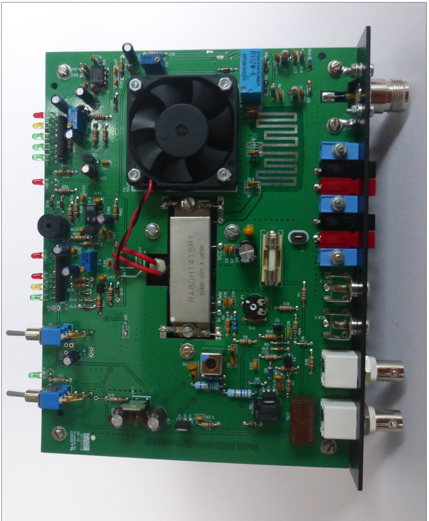
Bild 24: Ansicht der komplett bestückten Leiterplatte mit der montierten Frontplatte.
