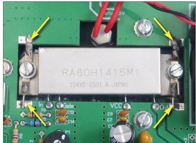
Bild 22: Leiterplattenausschnitt mit dem eingelöteten Powermodul; die vier Masseverbindungen zu den Lötflchen auf der Leiterplatte sind über Lötösen und dicke Drähte herzustellen.
