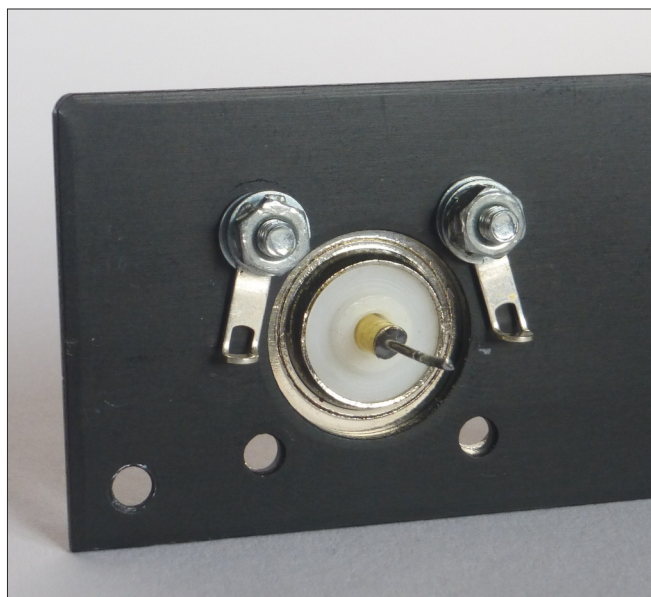
Bild 21: Vorbereitung der Rückplatte mit der eingebauten N-Buchse
